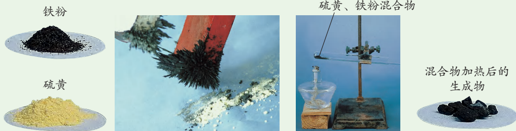
图2-38 铁粉和硫黄的实验
