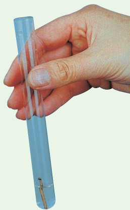
图1-20 盐酸与铁锈的反应
